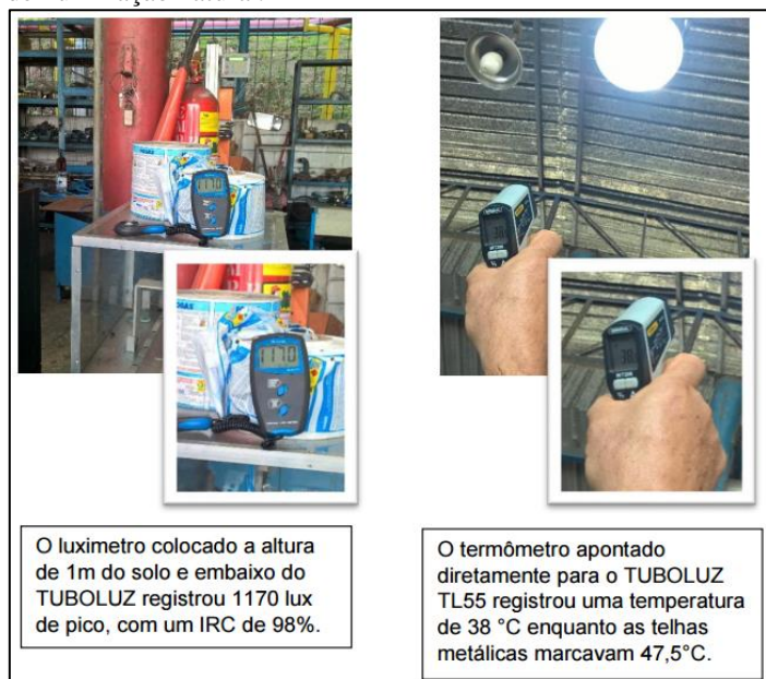
Figura 4 - Luximetria e Temperatura do ambiente com o sistema de iluminação natural.
