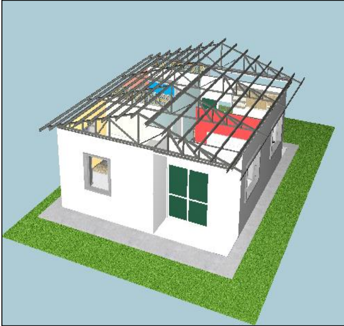
Figura 6: Detalhe de cobertura da edificação.
