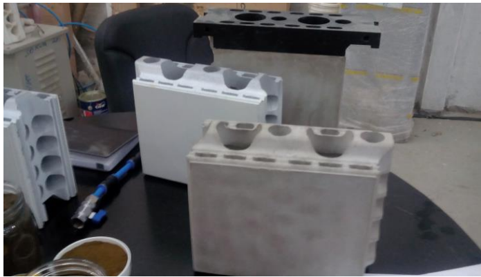
Figura 2 – Blocos construídos a partir da areia da Redestinação de resíduos sólidos da construção civil.
