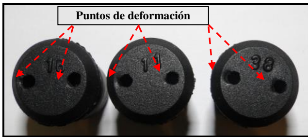
Figura 11 - Deformación en los bordes del agujero guía.
