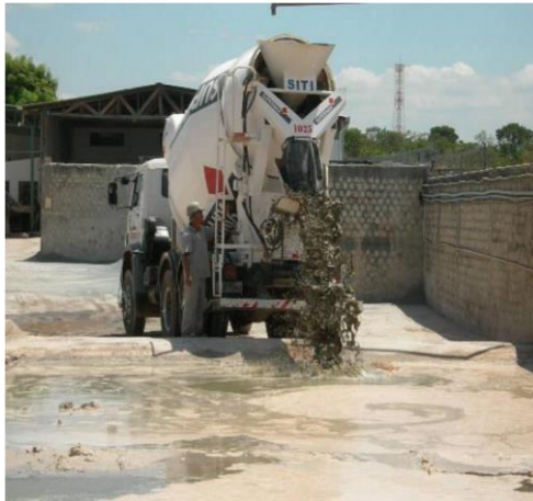
Figura 4.A - Lavagem do caminhão.
