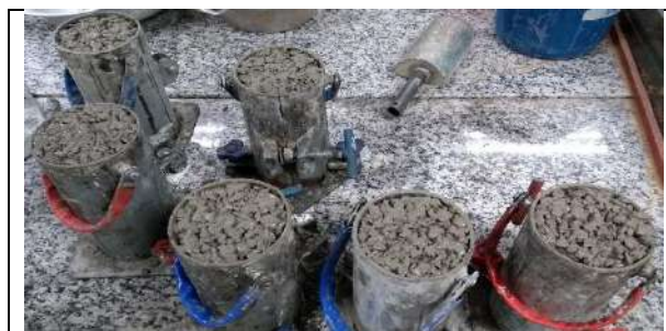
Figura 8 – Moldagem realizada dos corpos de prova do concreto permeável do traço referência.
