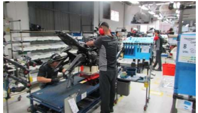
Figura 7 – Estação de trabalho 1 de montagem do chassi.
