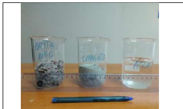
Figura 3 – Materiais base para a confecção do concreto permeável dentro de um copo de bequer.
