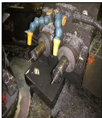
Figura 6 – Broca paralela e escareador. Fontes: Autores, (2019).
