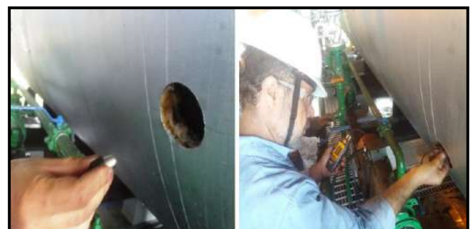
Figura 8: Medição do casco cilíndrico pelas janelas abertas no isolamento. Fonte: Autores, (2019).
