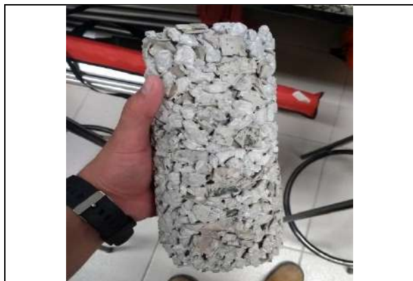
Figura 9 – Desforma do concreto permeável com as lascas de borracha após o prazo de 7 dias.
