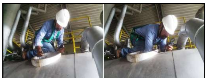
Figura 9: Medição interna do casco cilíndrico pelo lado da água e tubos. Fonte: Autores, (2019).
