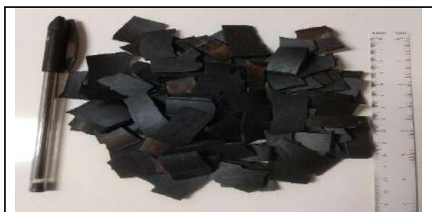
Figura 6 – Material usado no concreto permeável (borracha da câmara de ar para pneu), cortada em 20mm pronta para o uso.
