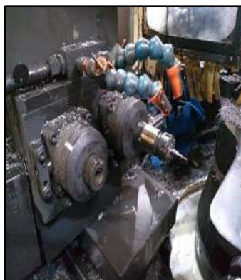
Figura 7 – Broca escalonada. Fontes: Autores, (2019).
