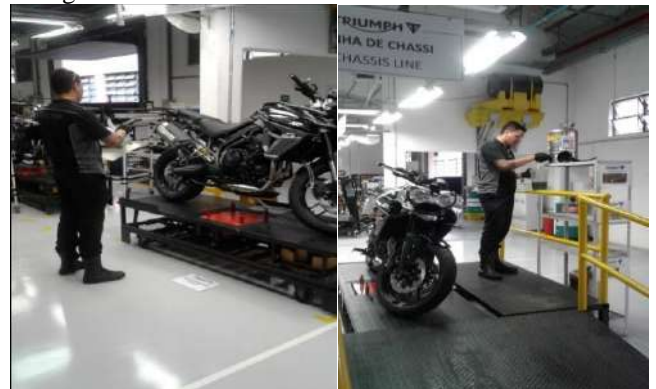
Figura 8 – Inspeção visual e abastecimento.
