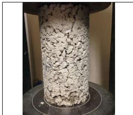
Figura 11 – Análise de compressão axial do corpo de prova do concreto permeável.
