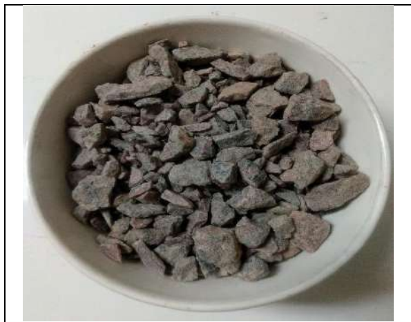
Figura 5 – Agregado (brita 0) disposto em um recipiente de porcelana usado para a confecção dos concretos.
