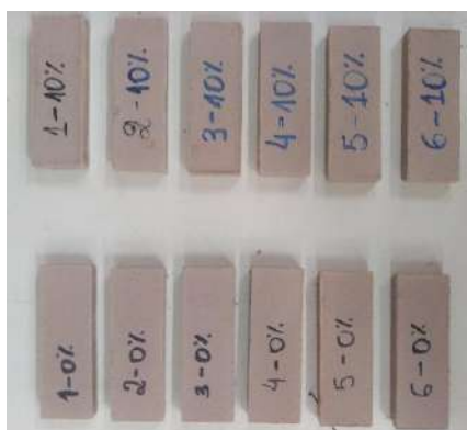
Figura 1: Corpos de Prova prensado antes da queima com 8% de água.
