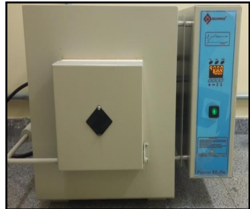
Figura 13: Forno Mufla utilizado para queima dos corpos de prova. Fonte: Autores, (2018).
