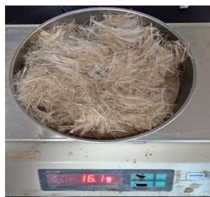
Figura 2: Fibra de Juta selecionada e cortada no tamanho de 20 mm preparada para a confecção do concreto.
