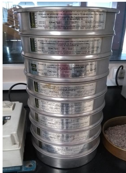
Figura 5: Peneiras utilizadas para o ensaio de caracterização dos agregados miúdo e graúdo. Fonte: Autores, (2018).
