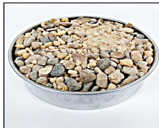
Figura 6: Recipiente utilizado para análise da massa unitária dos agregados miúdo e graúdo. Fonte: Autores, (2018).
