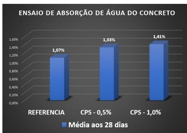
Figura 9: Gráfico da porcentagem média de absorção de água do concreto aos 28 dias
