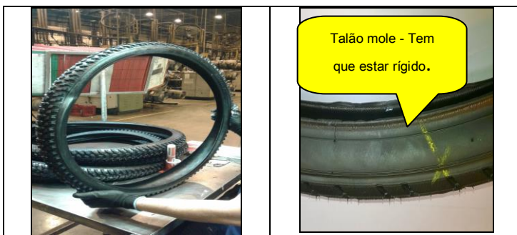
Figura 8 - Verificação de conformidade
