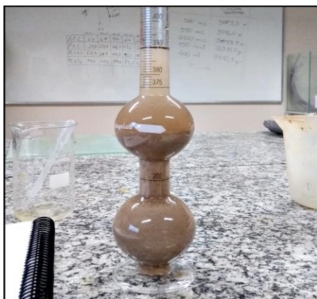
Figura 7: Frasco Chapman utilizado para executar o processo de determinação da massa específica do agregado miúdo.
