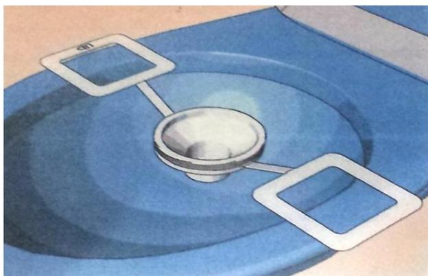
Figura 14. Encaixe e posicione o suporte na borda do vaso sanitário.
