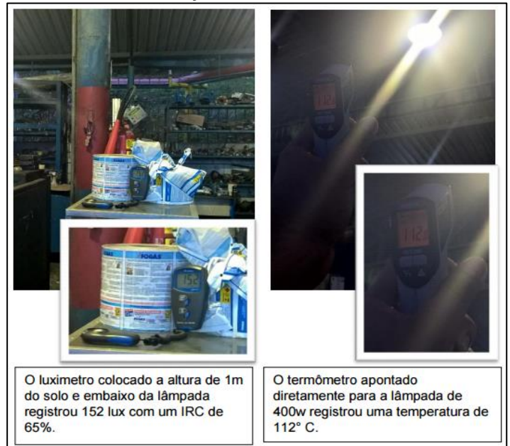
Figura 6: Luximetria e Temperatura do ambiente com o sistema convencional de iluminação.
