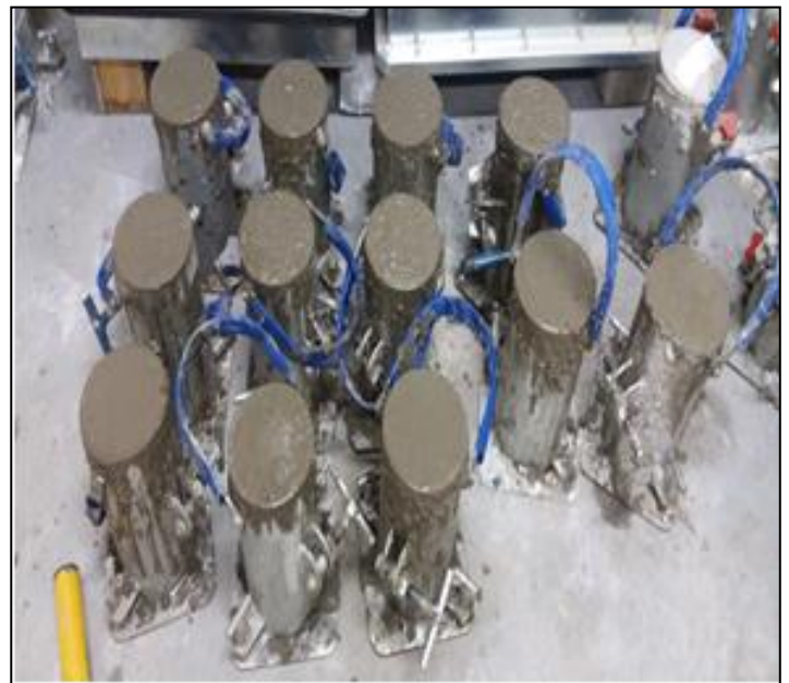
Figura 5: Moldagem dos corpos de prova.
