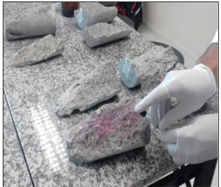
Figura 8: Início da aplicação do indicador químico de fenolftaleína nos corpos de prova. Fonte: Autores, (2018).
