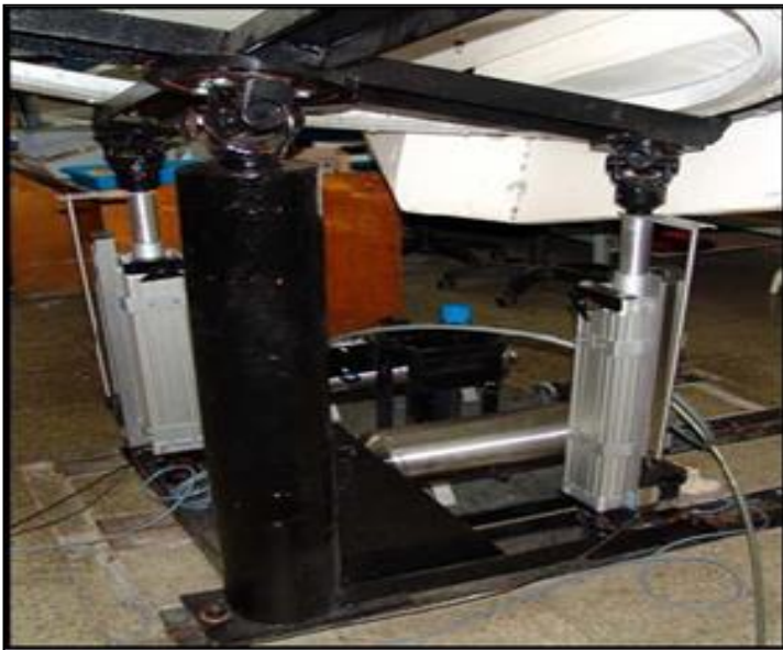
Figura 1: Simulador industrial de conducción SIMPRO de 2 GDL. Fuente: Autores, (2010).
