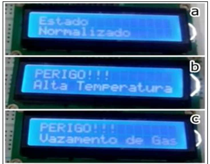
Figura 12: Estado normalizado (a), alta temperatura (b) e vazamento de gás (c). Fonte: Autores, (2018).
