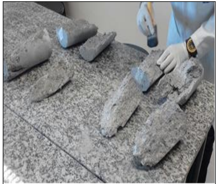
Figura 7: Limpeza dos CP's para aplicação do indicador químico de fenolftaleína.
