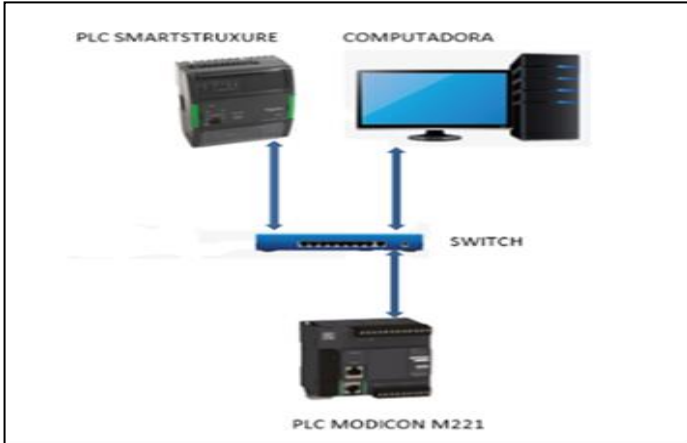
Figura 7: Conexión de los PLC al SCADA.
