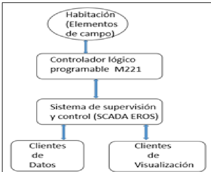
Figura 5: Partes del sistema SCADA.
