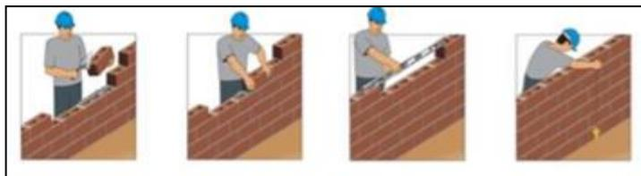
Figura 5: Assentamento de alvenaria
