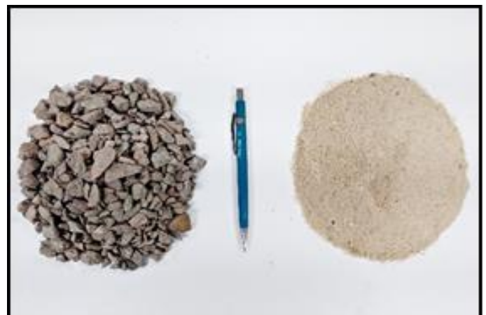
Figura 5: Agregados: à direita agregado miúdo (areia fina) e a esquerda agregado graúdo (brita 1 contínua), dispostos para comparação de tamanho entre si.
