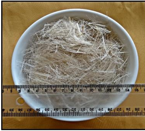
Figura 3: Fibras de malva, medidas e separadas minuciosamente para caracterização do material.
