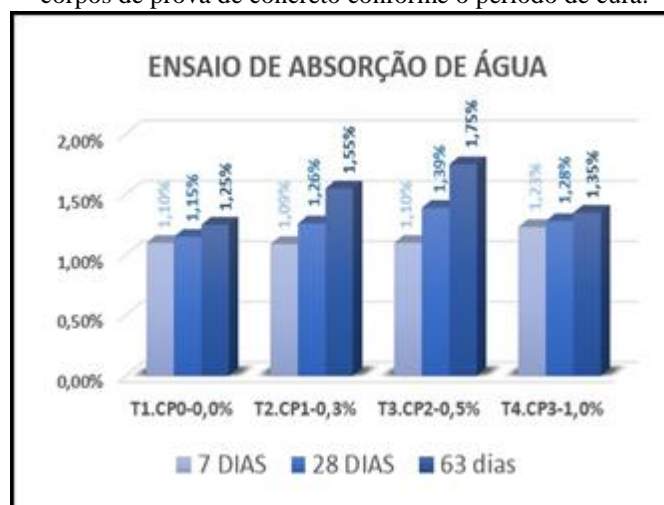
Figura 11: Gráfico da análise da média de absorção de água nos corpos de prova de concreto conforme o período de cura.
