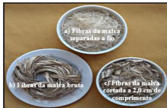
Figura 2: Preparação das fibras de malva para confecção dos concretos.
