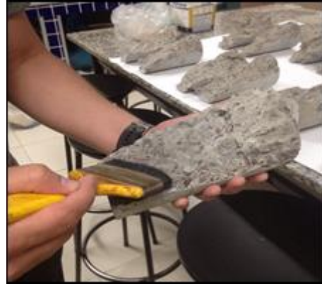
Figura 8: Limpeza dos corpos de prova de concreto com o auxílio de um pincel de cerdas macias com intuito de eliminar os resíduos deixados através da ruptura.
