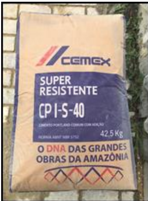
Figura 4: Cimento selecionado conforme as especificações da norma técnica NBR 5732.
