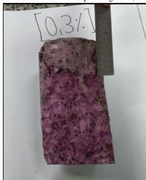
Figura 14: Corpo de prova com 0,3 % de adição das fibras de malva, observado aos 50 dias após aplicação do indicador químico de fenolftaleína. Observa-se, a área em destaque, que o processo de carbonatação está mais acelerado, devido à cor carmim está menos intensa que na figura 17, acima.
