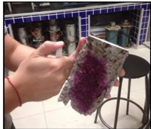
Figura 9: Aplicação do indicador químico de fenolftaleína nos corpos de prova de concreto com o auxílio do spray.
