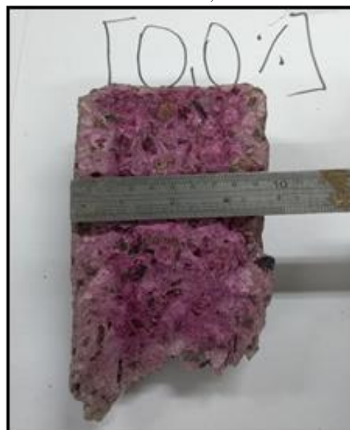
Figura 13: Corpo de prova com 0,0 % das fibras de malva, observado aos 50 dias após aplicação do indicador químico de fenolftaleína. Nota-se que a coloração centraliza-se no corpo de prova tornando-a mais intensa; área não carbonatada.
