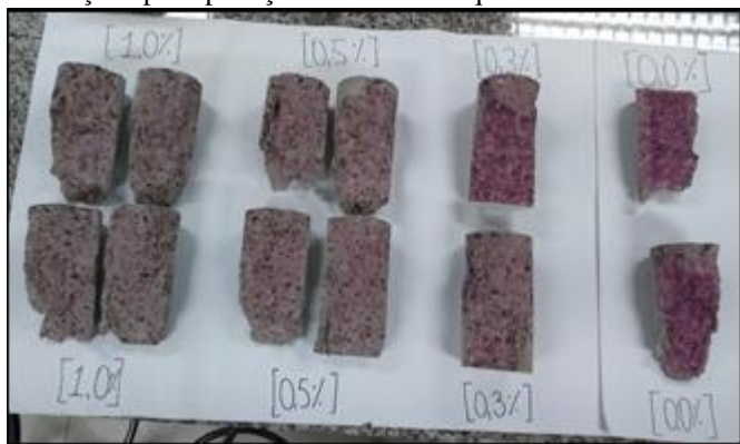
Figura 15: Corpos de prova expostos e analisados aos 93 dias de observação após aplicação do indicador químico de fenolftaleína.
