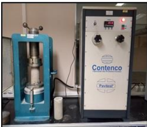
Figura 7: Corpo de prova no processo de ruptura através da prensa hidráulica elétrica.
