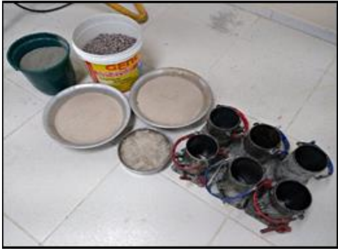
Figura 6: Materiais disposto para a confecção dos corpos de prova de concreto tanto convencional quanto com adição das porcentagens de 0,3%, 0,5%, 1,0% das fibras de malva.
