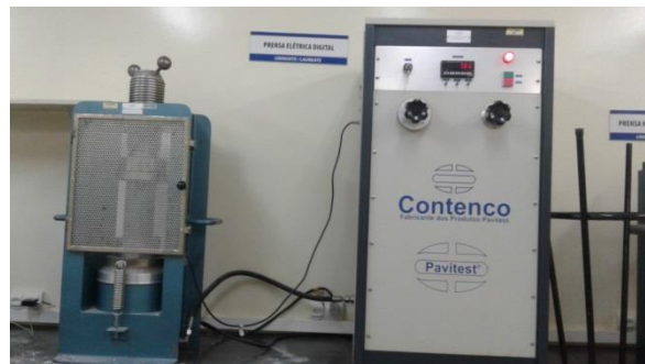
Figura 3: Prensa elétrica digital utilizada nos ensaios de resistência a compressão.
