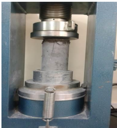
Figura 4: Corpo de prova sendo rompido. Fonte: Autores, (2018).
