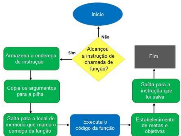
Figura 19: Fluxo do programa utilizando funções especiais.
