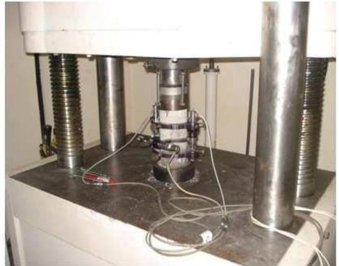
Figura 13: Ensaio á Compressão axial.
