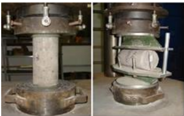
Figura 10: Aplicação do carregamento de compressão no corpo de prova. Fonte: Autores, (2018).
