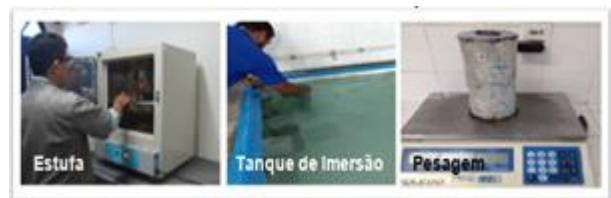
Figura 8. Fases do ensaio de absorção. Fonte: Autores, (2018).
