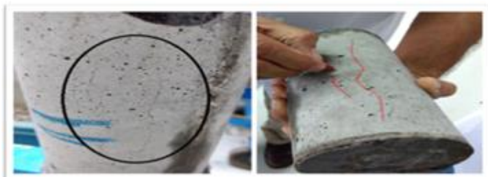
Figura 9: Em destaque microfissuras propositalis. Fonte: Autores, (2018).
