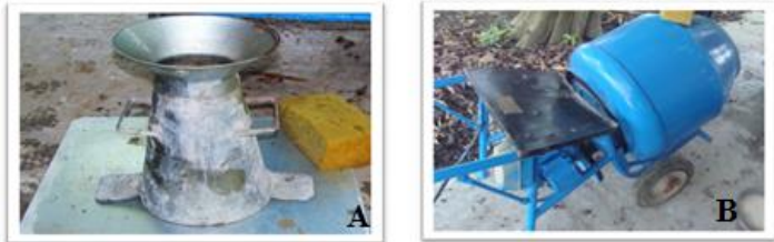
Figura 4: (A) Conjunto de cone de Abrams marca MATEST. (B) Betoneira 130L. Fonte: Autores, (2018).
